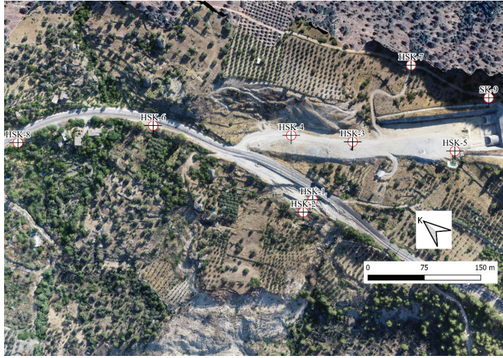
Şekil 8. Çalışma alanındaki sondajların dağılımı. Figure 8. Distribution of boreholes in the study area.
