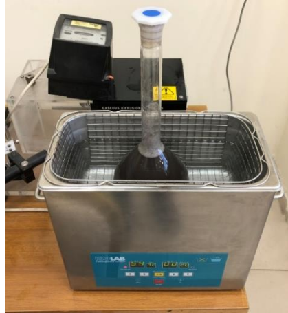
Şekil 2. Nanoakışkan çözeltisine uygulanan ultrasonik banyo işlemi
