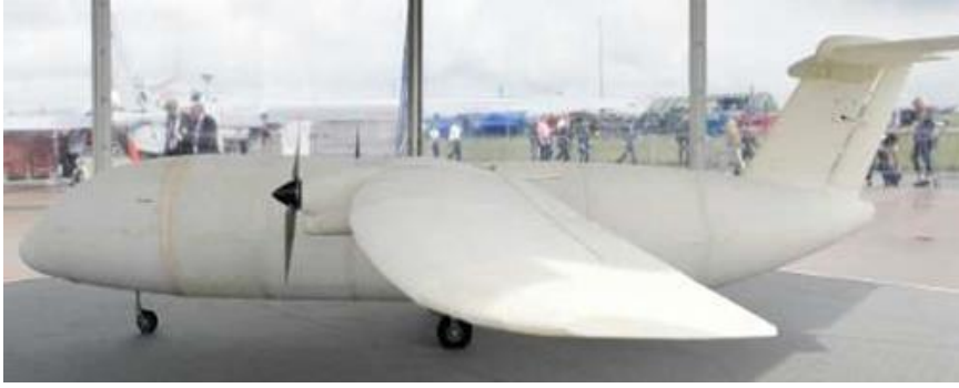
Şekil 13. Airbus'ın ürettiği dünyanın ilk katmanlı imalat uçağı (Najmon vd., 2019)
