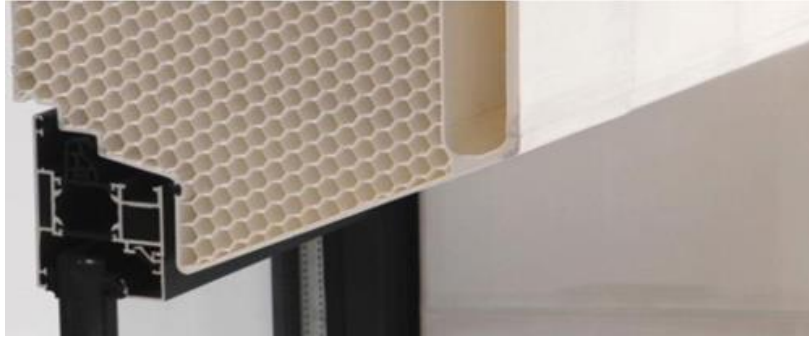
Şekil 22. FDM teknolojisi ile üretilmiş cephe bileşeni (Çalışkan vd., 2020) Figure 22. Facade component designed with FDM technology (Çalışkan et al., 2020)
