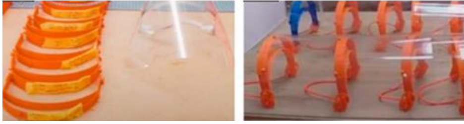
Şekil 18. Katmanlı imalat yöntemiyle üretilmiş yüz siperlikleri (Vafadar vd., 2021) Figure 18. Face shields produced by the additive manufacturing method (Vafadar et al., 2021)
