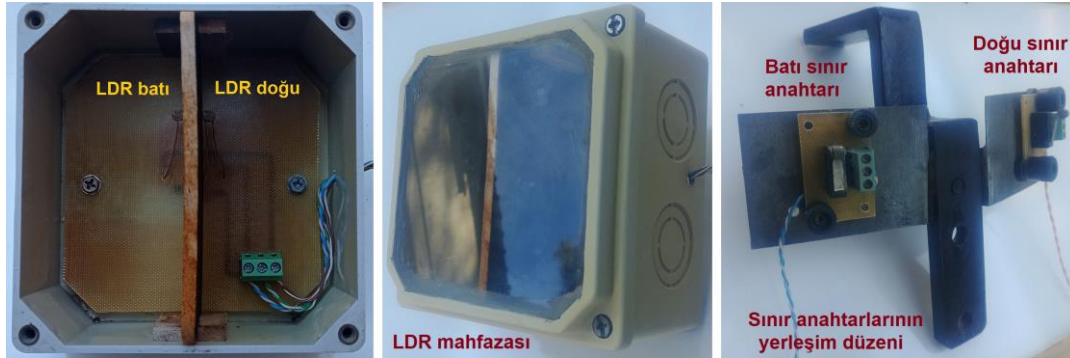
Şekil 7. LDR sensörlerinin ve sınır anahtarlarının yerleşim düzeni.
