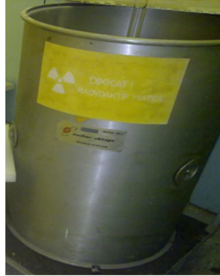
Şekil 2. Pu-Be Howitzer nötron kaynağı (Pu-Be Howitzer neutron source).
