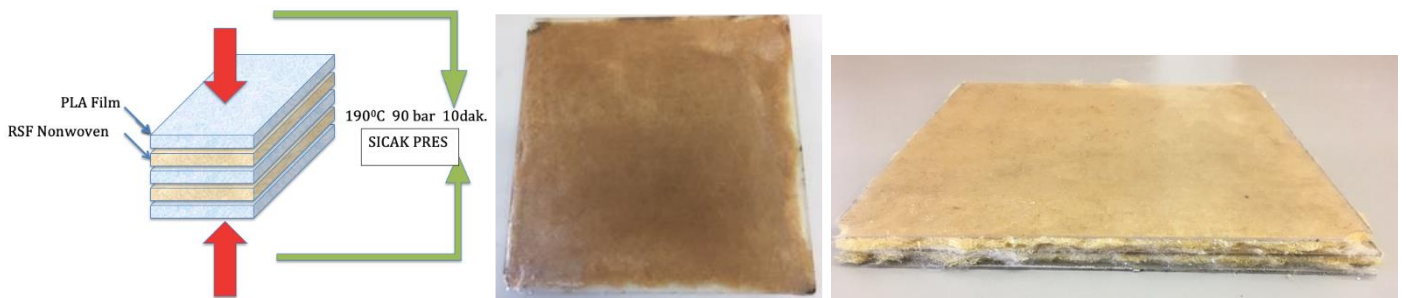
Şekil 7. Çift Katlı Kompozit Malzeme [25]
