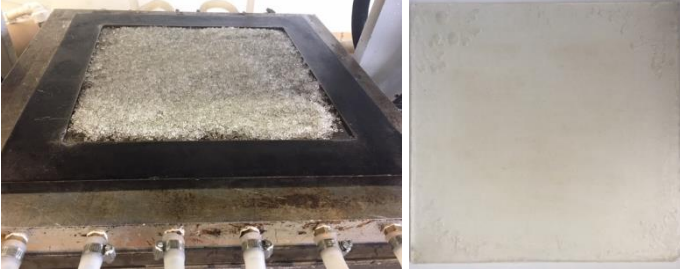
Şekil 5. Çelik kalıp içinde Granül PLA ve basılmış plaka hali [22]
