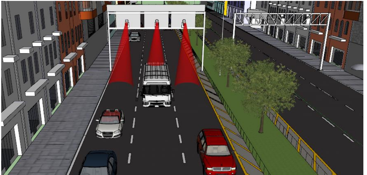
Şekil 5. Değişken mesaj sistemlerinin arkasında yer alan örnek bir plaka okuma ve görüntü işleme ile araç tespit sistemi (A sample license plate reading and vehicle detection system with image processing behind variable message systems)
