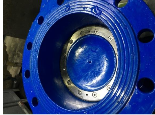
Şekil 16. Basınç testine alınan gövde ve klape düzeneği
