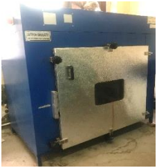
Şekil 1. Kurutma (ısıl işlem) fırını (1 m 3 )
