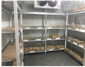
Şekil 1. Kurutma (ısıl işlem) fırını (1 m 3 )
