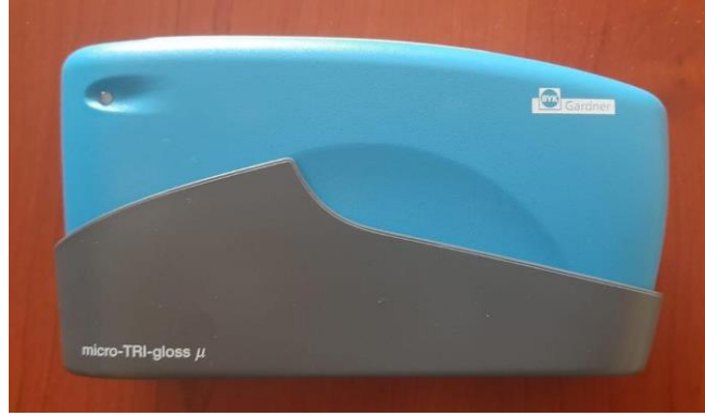
Şekil 4. BYK Gardner Micro-TRI-gloss \mu (Gloss meter) cihazı
