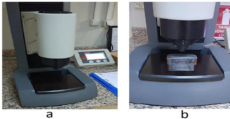
Şekil 11. Emcotest Durajet sertlik ölçüm cihazı; a) Sertlik ölçüm cihazı dış görünüşü b) Numunelerin sertliğinin ölçülmesi [5]
