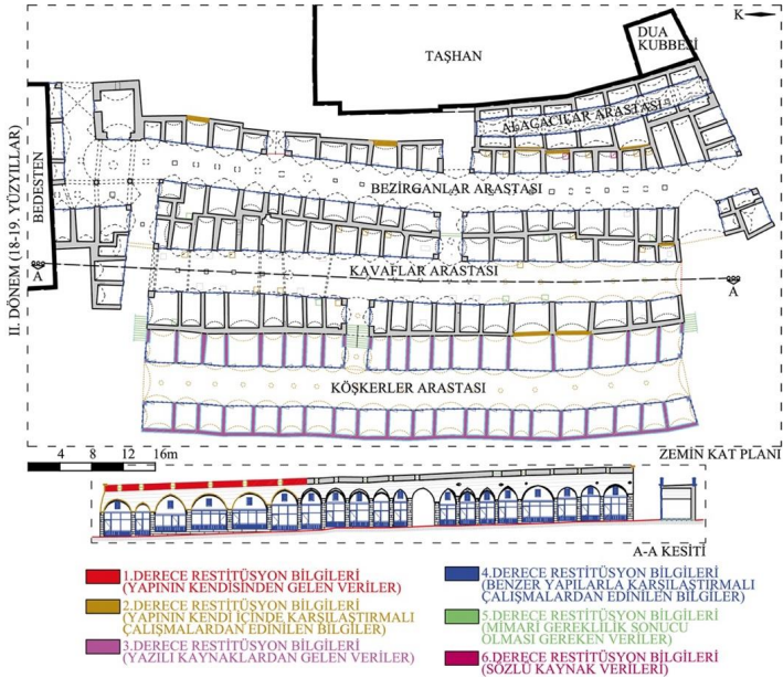
Çiz.9: Maraş Kapalı Çarşısı III. Dönem (18. - 19. yüzyıllar) restitüsyon planı (EHA Yapı Mimarlık)
