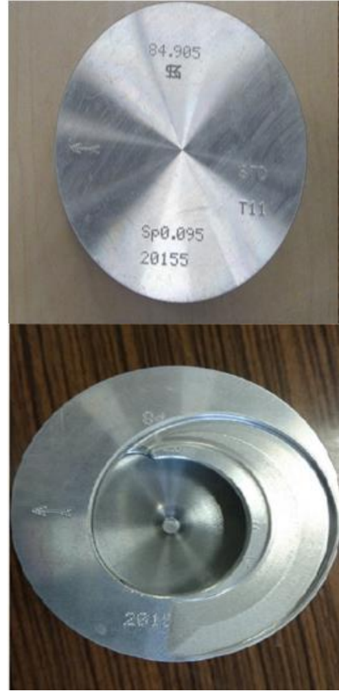
Şekil 1. Ham (Solda) ve işlenmiş (sağda) pistonlar (Rough and manufactured pistons)
