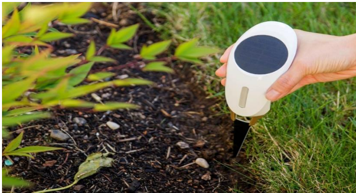
Şekil 4. Toprağın nemini ölçen ve yetersiz olduğu durumlarda uyarı veren bir bitki sensörü
