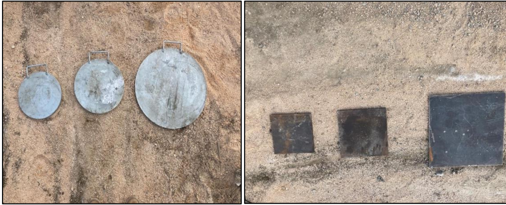
Şekil 2. Daire ve Kare Kesitli Model Temeller
