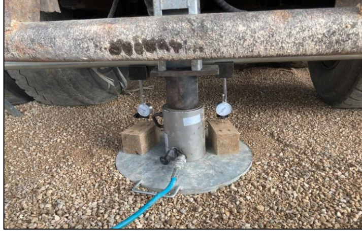
Şekil 6. Deney Sırasında Pistonun ve Deplasman Ölçerlerin Konumları
