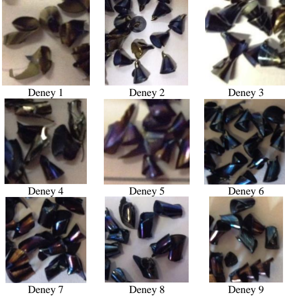
Şekil 16. Farklı kesme hızlarında oluşan talaş formları
