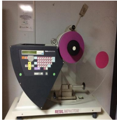
Fig. 6. Izod Test Device.
