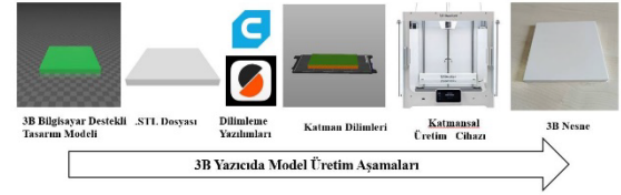
Şekil 1. 3B baskıyı elde etme süreci
