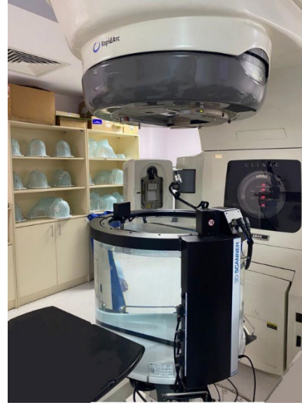
Şekil 3. Varian DHX cihazında su fantomu ile ölçüm
