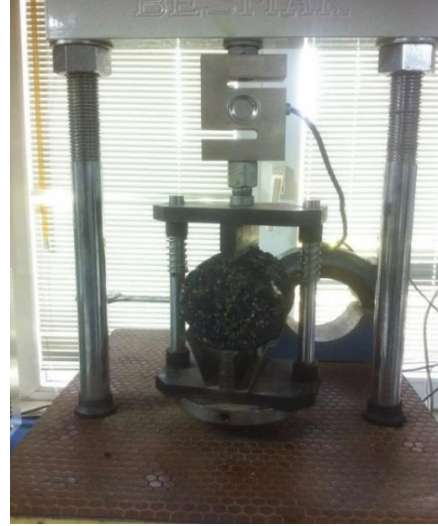
Şekil 9. Koşullandırılmış ve koşullandırılmamış numunelere kuvvet uygulanarak kırılma yükünün bulunması
