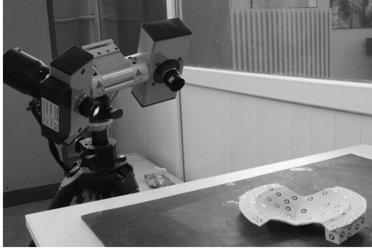
Şekil 3. Nakajima numunelerinin optik tarama cihazı ile taranması
