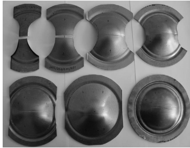
Şekil 2. Şekillendirilmiş Nakajima numuneleri
