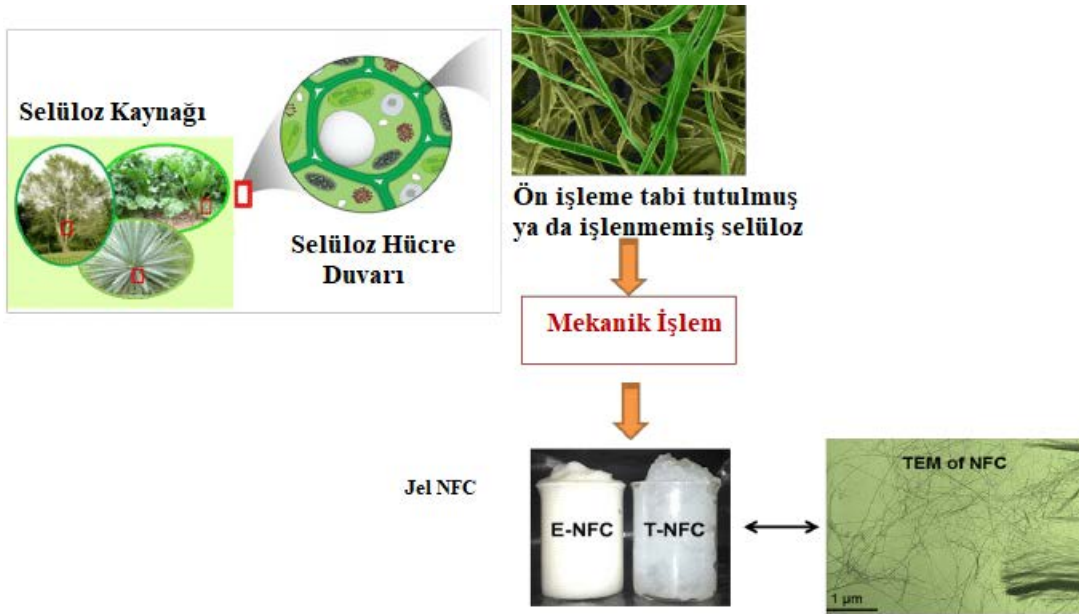
Şekil 6. Farklı selüloz kaynakları (odun veya yıllık bitki), ardından farklı mekanik işlemler kullanılarak selüloz liflerinin hücre duvarından ekstraksiyonunun yapılması ve NFC jel süspansiyonu eldesi (Missoum vd., 2013).
