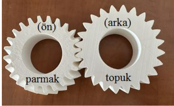
Şekil 15. Eriyik yığıma modelleme ile imal edilmiş konikvari dişliler (Beveloid gears manufactured with FDM Method)
