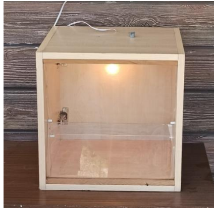
Şekil 4. Akçamescit Deposuna yerleştirilen ışık tuzak
