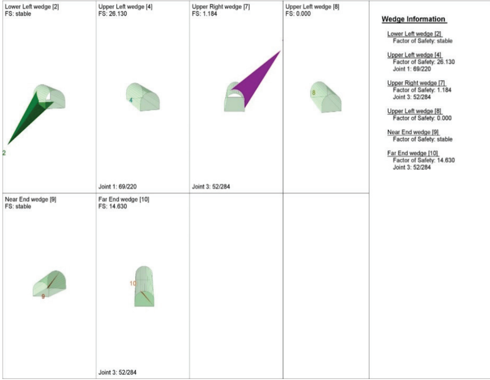
Figure 7. Tunnel entrance right tube (Km 25+427 – 25+434) probable wedge failures and their factor of safety values Şekil 7. Tünel giriş sağ tüp (Km 25+427 – 25+434) olası kama tipi kaymalar ve bunlara ait güvenlik sayısı değerleri
