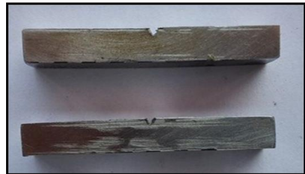
Şekil 4. Çentik darbe testleri için hazırlanan numune örnekleri (Sample samples prepared for notch impact tests)
