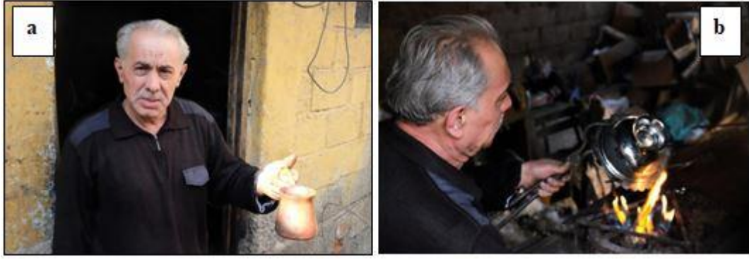
Foto 9. a) Kalay Ustası Hüseyin AKGÜN b) Kalaylama işlemi
