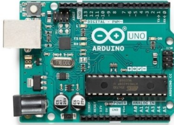
Şekil 1. Arduino Uno Mikrodenetleyici Modülü [30]
