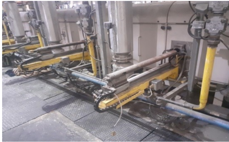
Şekil 5. Alüminyum Billet Tav Ocağı Termokuplu
