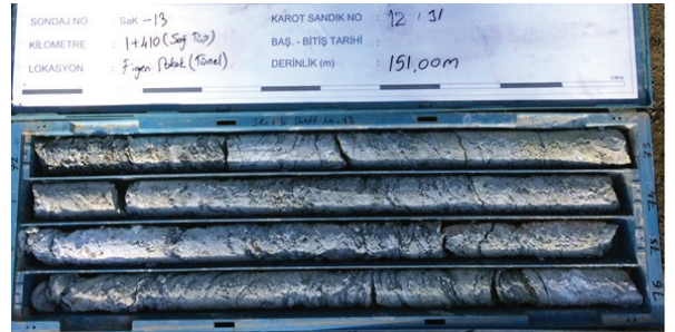
Şekil 14. SaK-13 sondajının 72,00-76,00 metreleri arasına ait karot fotoğrafları.
