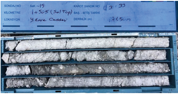
Şekil 15. SaK-15 sondajının 122,00-125,00 metreleri arasına ait karot fotoğrafları.
