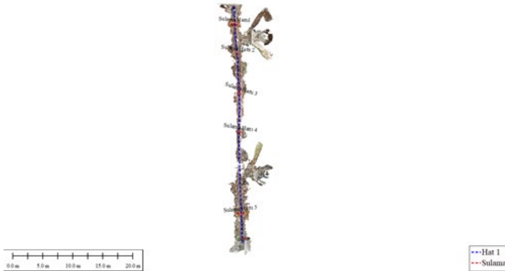
Şekil 11. Doğalgaz boru hattının diğer altyapı elemanlarıyla birlikte ilişkilendirilmesi-Kesit alınması ve doğrultuların belirlenmesi.
