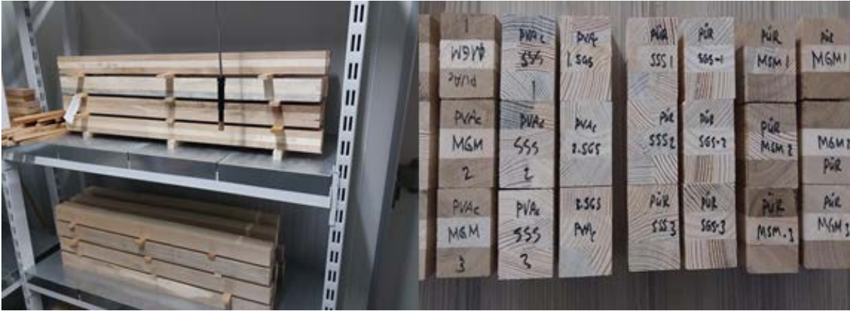
Şekil 2. Lamine keresteleri iklimlendirme kabini içinde kondisyonlanması
