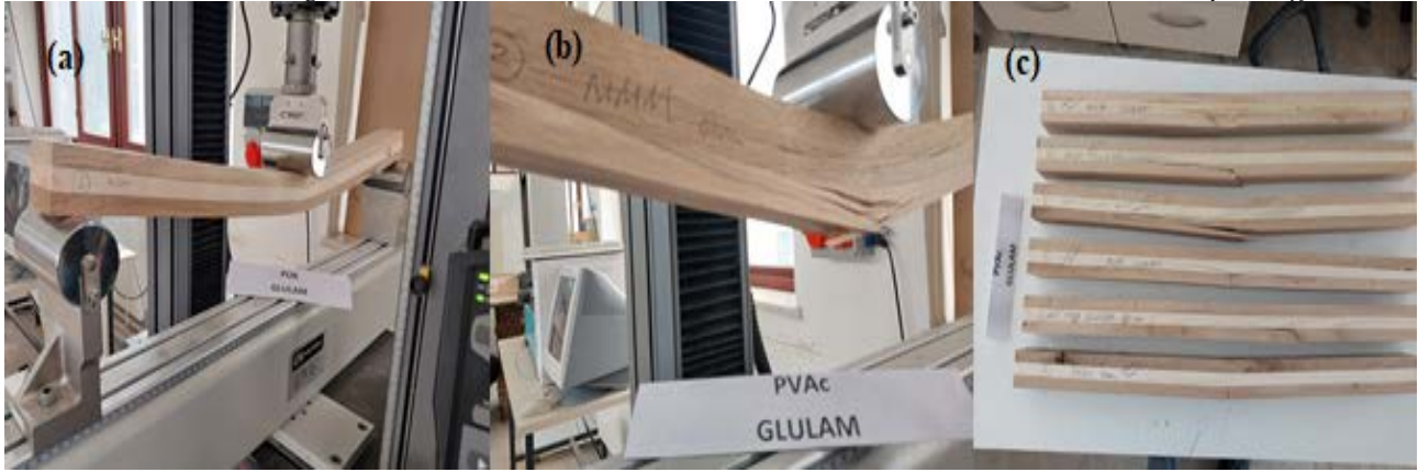
Şekil 3. Eğilme direnci ve eğilmede elastikiyet modülünün tespiti; (a) ve (b) Statik eğilme deney düzeneği, (c) Statik eğilme deney sonrası numuneler
