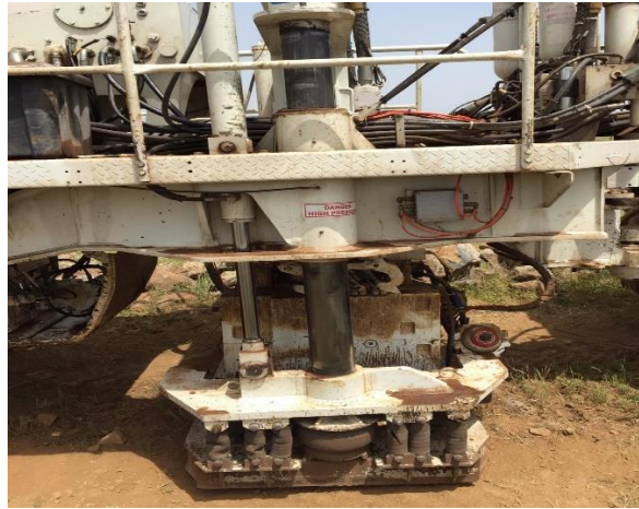
Şekil 1. Atış düzeni (sismik enerji kaynak düzeni) oluşturan vibratörler (üstte) ve yer yüzeyine temas eden vibro çelik tablası (Vibrator pattern in operation (above) and base plate coupling with the surface (below)).
