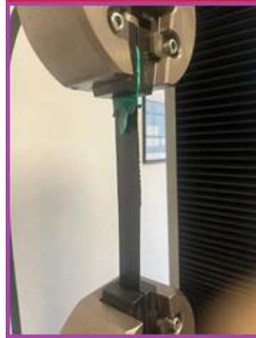
Şekil 2. SHIMADZU HARDWAY çekme deney cihazı (SHIMADZU HARDWAY tensile test device)
