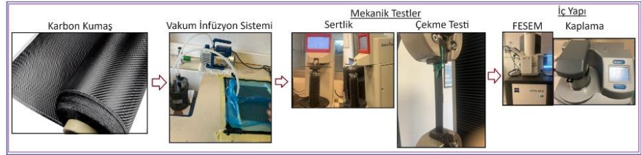
Şekil A: Numune Üretimi ve Deney Sürecinin Şematik Gösterimi / Figure A: Schematic Representation of Sample Production and Experimental Process
