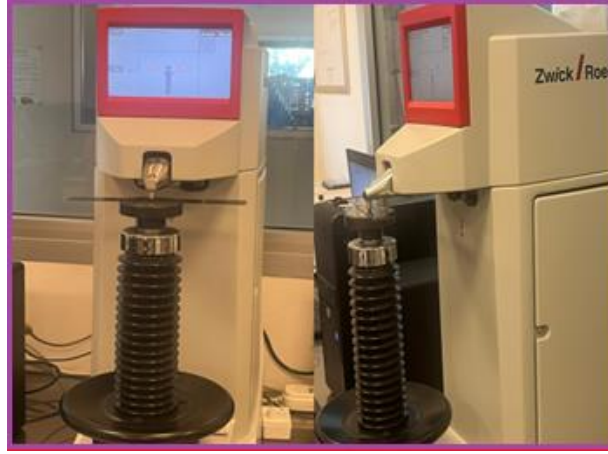
Şekil 3. Zwick Roell rockwell sertlik ölçüm cihazı (Zwick Roell rockwell hardness tester)
