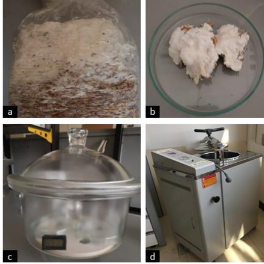
Şekil 2. (a) İstiridye mantar miselyumunun temin edildiği şekli, (b) bir parçası. Üretimde kullanılan (c) desikatör ve (d) otoklav.
