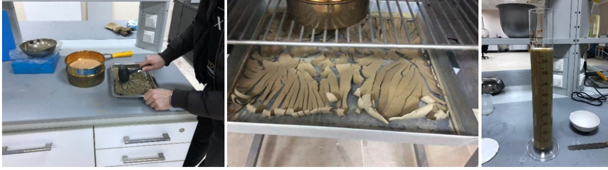
Şekil 3. Zeminin granülometrisi çıkartılma işlemleri
