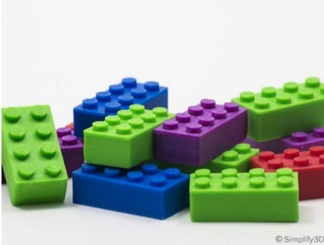
Görsel 2. ABS Filament Baskı Örneği (Simplify3D, 2021).
