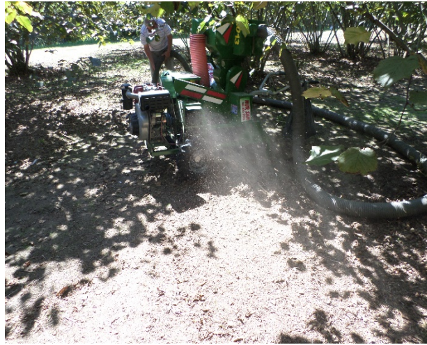
Şekil 1. Pnömatik fındık toplama makinasının çalışma alanındaki genel görünüşü
