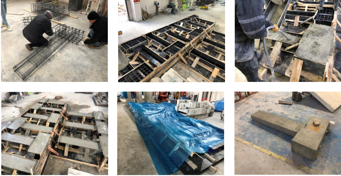
Şekil 2. Deney elemanlarının üretim ve kür aşamaları
