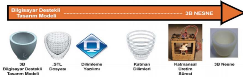
Şekil 1. Üç boyutlu yazıcıların üretim süreci
