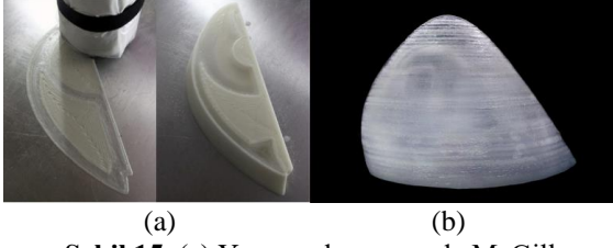
Şekil 15. (a) Yarışma kapsamında McGill Üniversitesi'nin yalıtımlı robotik kola sahip soğutma tesislerinde tuzlu su destek yapısı ve su buzu basımı gerçekleştirildi (b) Tuzlu su destek yapısının erimesinden sonra kalan 3D baskılı buz yapısı (Morris ve diğerleri,2016)
