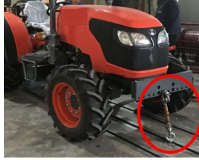
Şekil 14. Traktörün Ön Kısımının Zemine Sabitlenmesi (Fixing The Front of The Tractor To The ground)
