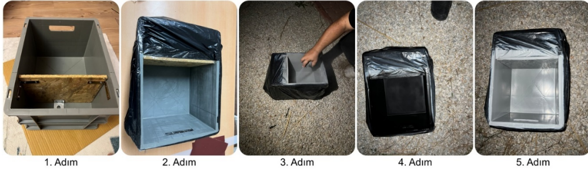
Şekil 2. Taşınabilir mantar görüntüleme sistemi fiziksel ortam imalat aşamaları
