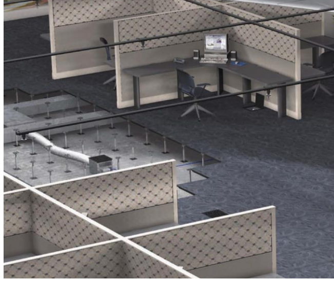
Şekil 1. Yükseltilmiş döşeme sisteminin bir büro mekanında kullanımı (Use of raised floor system in an office space) [7].
