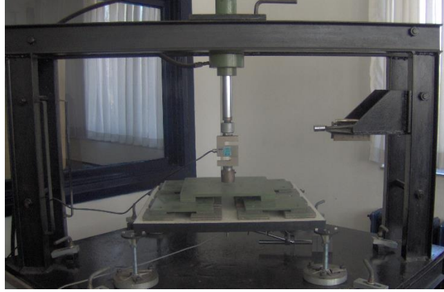
Şekil 3. Yayılı yük deney düzeneği (Uniform load test setup)
