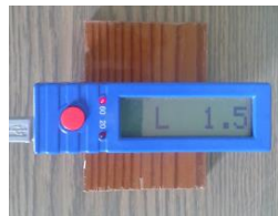
Şekil 3. Yüzey parlaklık ölçüm cihazı (Surface gloss meter) [12].
