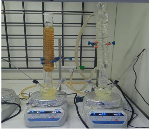
Şekil 4. Üç boyunlu kesikli reaktör deney düzeneği
