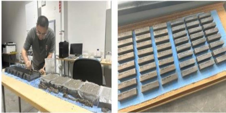
Şekil 3: FDM katkıli tuğlaların üretimi aşaması (Li vd., 2024).
