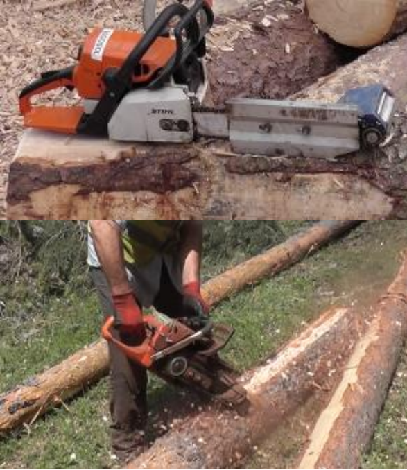
Şekil 2. Kabuk soymada kullanılan ve motorlu testereye takılan ekipmanla çalışma.
