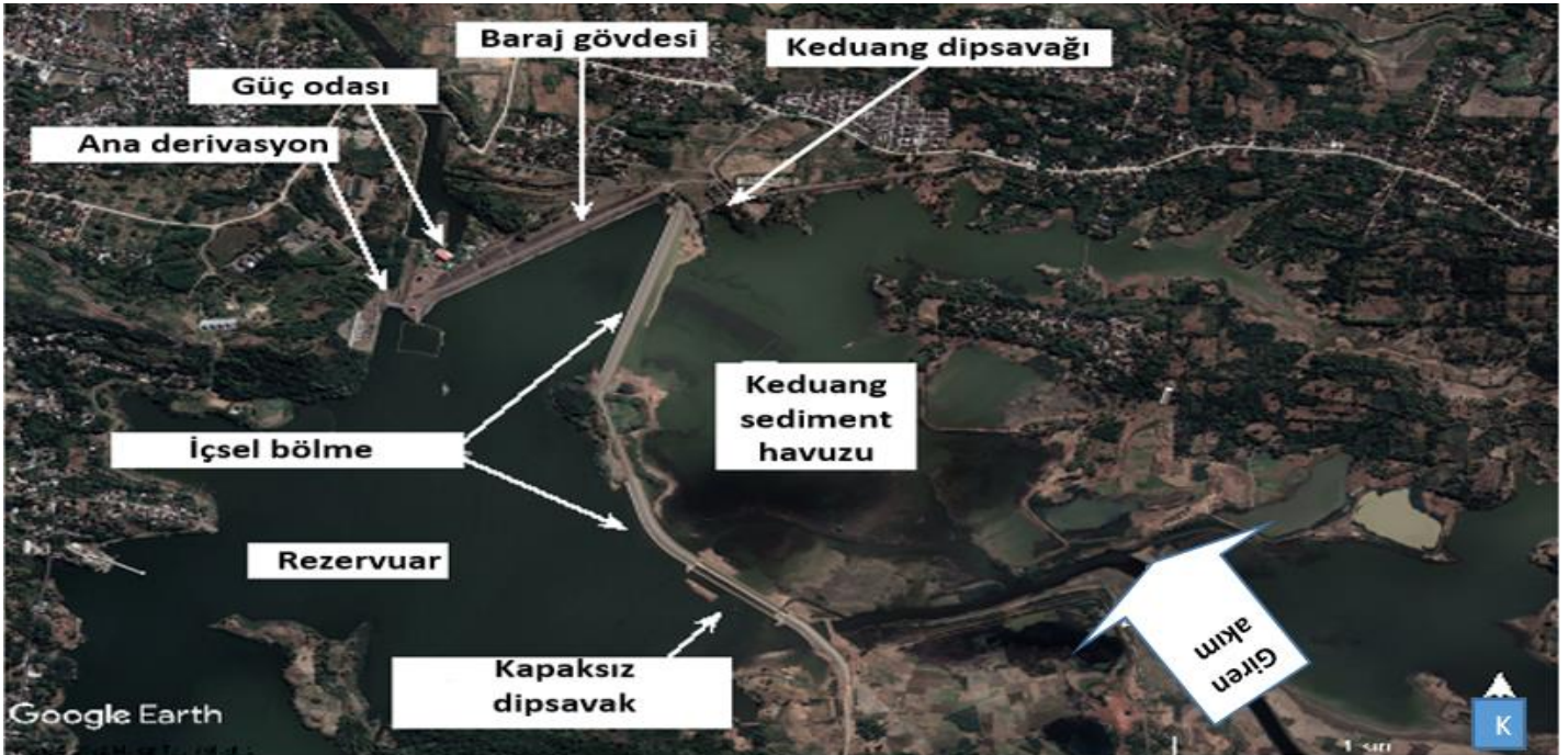
Şekil 3. Bölmeli rezervuar örneği
