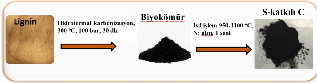
Şekil 1. Kendinden kükürt katkılı karbonların sentez basamakları (Synthesis steps of self-sulfur doped carbons)
