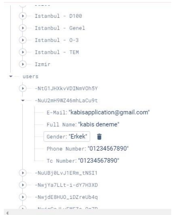
Şekil 3. Kullanıcıların Firebase Realtime Database'de saklanması
