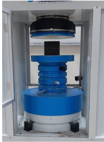
Şekil 3. Basınç dayanımı deneyi
