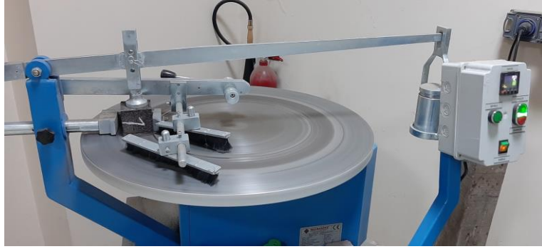
Şekil 7. Böhme aşınma deneyi
