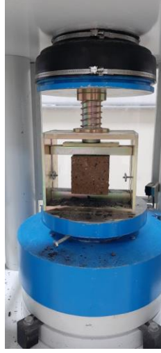
Şekil 4. Yarmada çekme dayanımı deneyi
